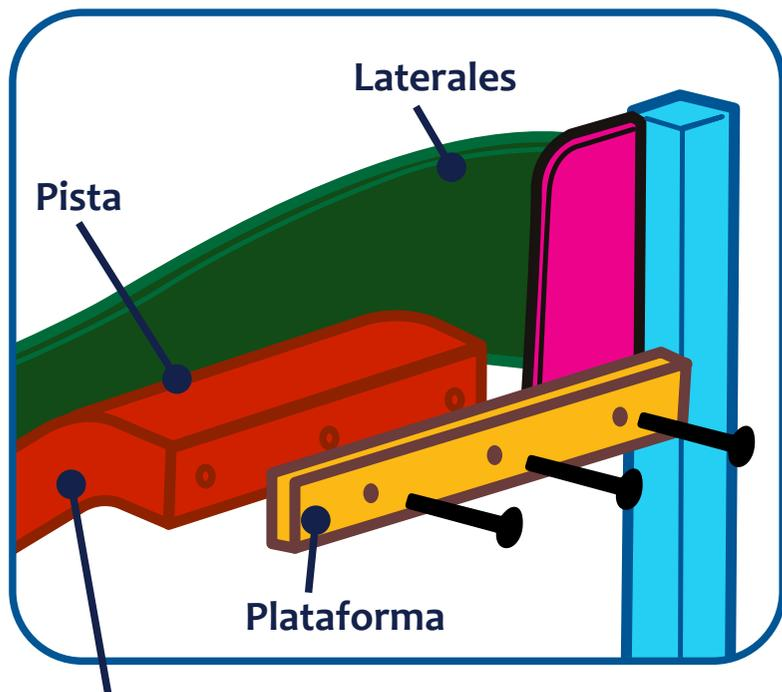
Pestaña lateral a 90° de la pista para instalación atornillada a paneles.
