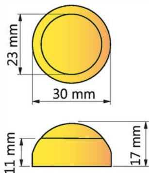
Tapones de seguridad para tornillos M8
