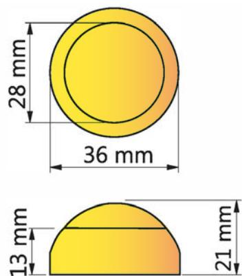
Tapones de seguridad para tornillos M10 y M12
