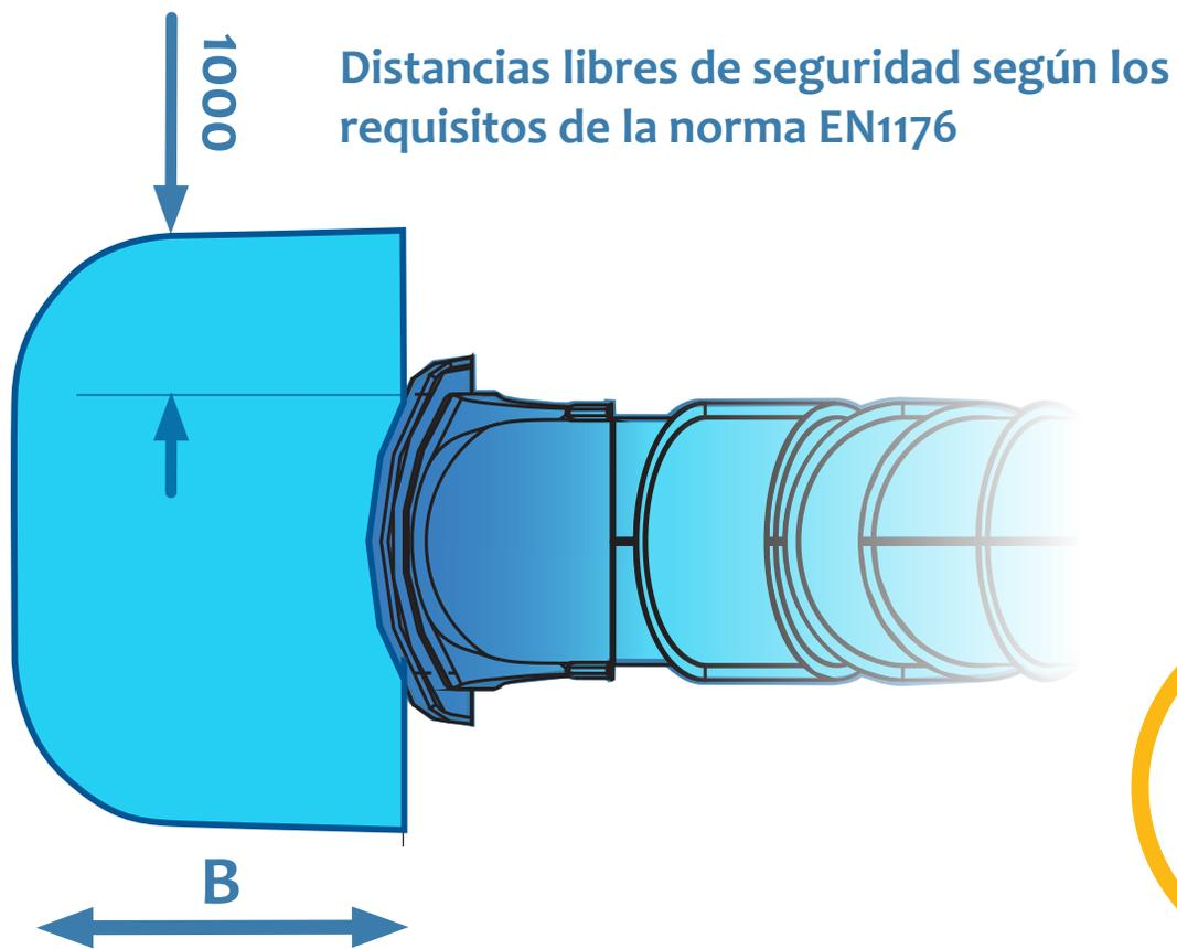
\* Distancia de seguridad (B) específica para cada modelo
